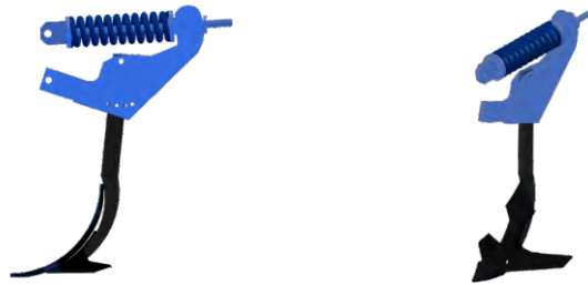
Зуб типа Vogel&Noot с двусторонним сердцевидным сошником, пружинный грядиль 35x35 мм или защита Нон-стоп
