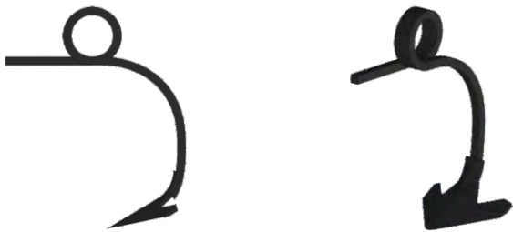
Зуб SG с пружинным грядилем 25x25 мм, сошник шириной 260 мм
