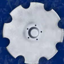
Диск, работающий с большим углом атаки
