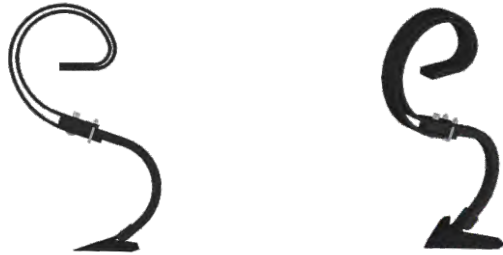
Зуб SX с усиленной двойной пружиной 50x10 мм, сошник шириной 260 мм
