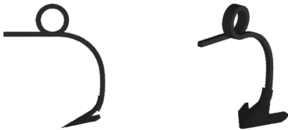
Ząb SG z grzędzielą sprężynową 25x25mm, redlica o szerokości 260mm
