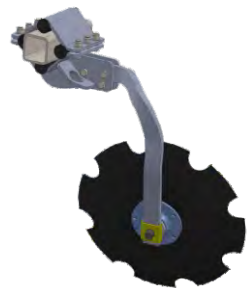
Talerz 620 mm grządziel PRO+ amortyzator gumowy LongLife 50x210 mm
