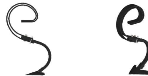
Dente SX con doppia molla rinforzata 50x10mm, vomere di larghezza 260mm
