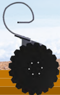
Disque 510 mm/560 mm amortisseur à ressort 13x100 mm (dents fines)
