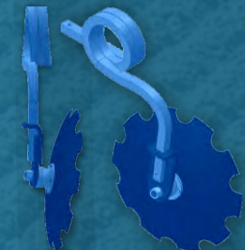
Amortyzator 3D ze sprężyną 35x35mm, zastosowany w maszynach U 652
