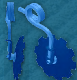
Amortiguador 3D con muelle 35x35 mm, utilizado en las máquinas U 652
