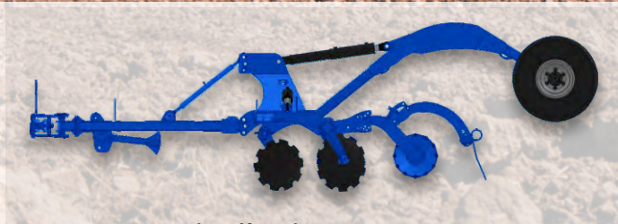
Wersja półzawieszana (dyszel + wózek transportowy LONG) ze zgrzeblą sprężynowym za wałem doprawiającym
