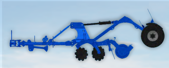
Wersja półzawieszana (dyszel + wózek transportowy) ze zgrzeblą sprężynowym pomiędzy talerzami a wałem doprawiającym
