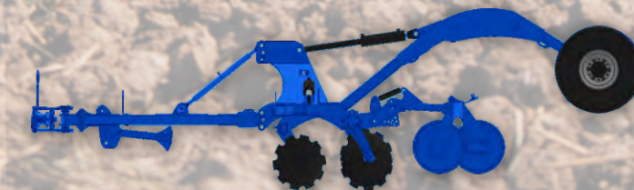
Wersja półzawieszana (dyszel + wózek transportowy LONG) z wałem tandem U-ring
