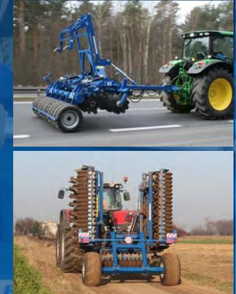
**Kupplung der Sämaschine mit Scheibenegge in der angehängten Version und der halb-angehängten Version**
