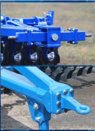
**Mechanische und hydraulische Tiefeneinstellung**
