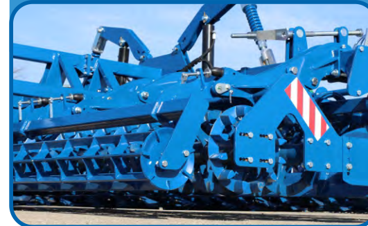
Двойной каток Crosskill Ø 400 mm + струнный каток Finisher Ø 270 mm
