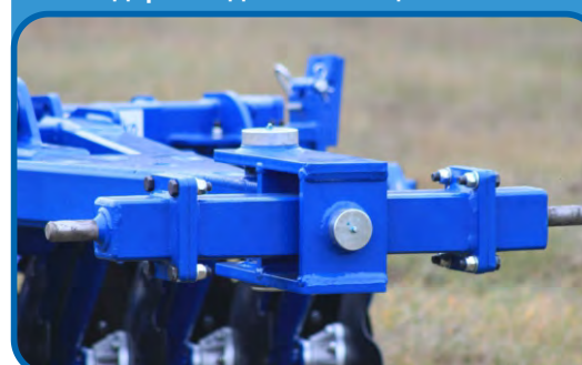
Стандартное дышло со сцепной балкой
