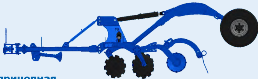
Версия прицепная (дышло + транспортная тележка LONG) с пружинной скребницей за прикатывающим катком
