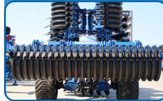
Призматический каток ORION Ø 500 mm
