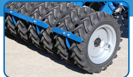
Двойной каток струнный зубчатый Ø 320 mm
