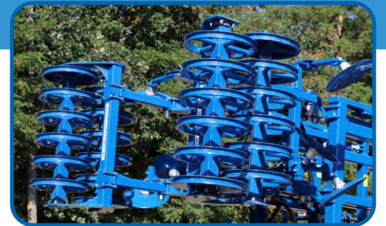
Пружинный каток Ø 550 mm + мульчирующий каток Ø 500 mm
