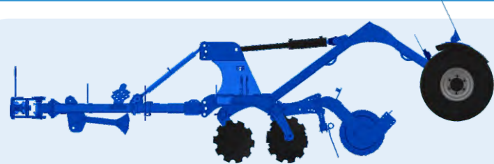
Версия прицепная (дышло + транспортная тележка) с пружинной скребницей между дисками и прикатывающим катком
