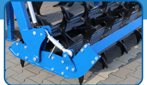
Шиповидный каток Ø 560 mm
