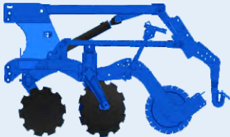
Wersja zawieszana ze sprzęgiem do siewnika
