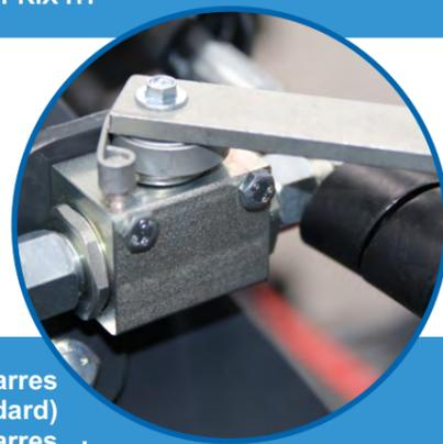
Soupape de sûreté à ressort protégeant contre le dépliage accidentel des bras des machines à pliage hydraulique
