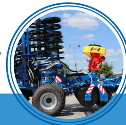
Un aménagement du semoir APV ou Delimbe sur une machine de préparation du sol Rolmako
