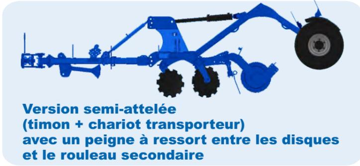
**Version semi-attelée (timon + chariot transporteur) avec un peigne à ressort entre les disques et le rouleau secondaire**
