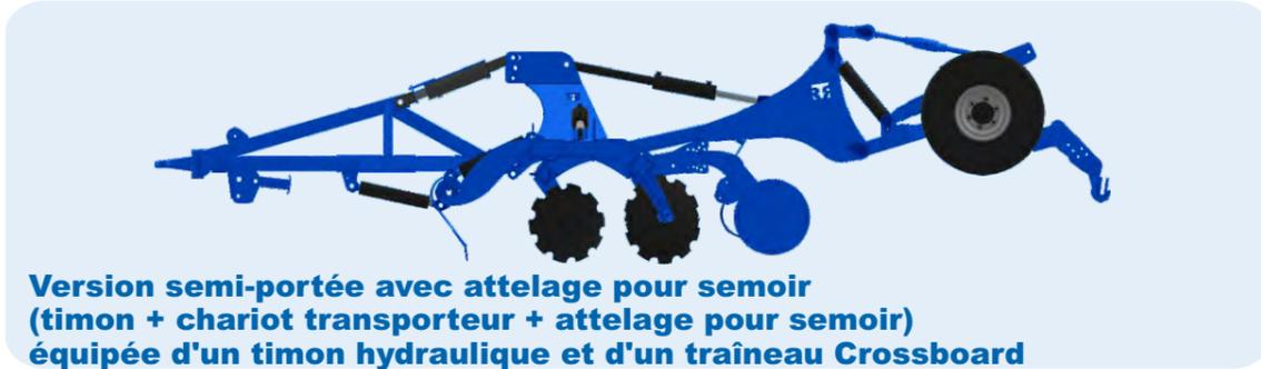
**Version semi-portée avec attelage pour semoir (timon + chariot transporteur + attelage pour semoir) équipée d'un timon hydraulique et d'un traîneau Crossboard**
