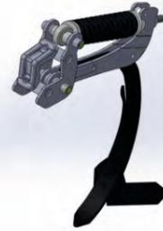
Tous les cultivateurs de la série U 436 (PREMIUM et versions antérieures) sont équipés d'une protection à ressort avec un double ressort renforcé qui presse la dent avec une force supérieure à 600 kg.
