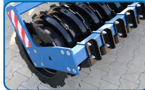
Rouleau tandem à barre dentée Ø 320 mm
