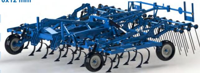
H - machines à pliage hydraulique, la largeur de transport ne dépasse pas 3 m.
