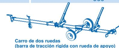
Carro de dos ruedas (barra de tracción rígida con rueda de apoyo)
