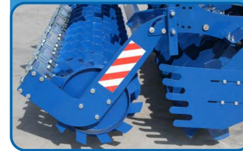
Rodillo de anillos de acero 48-52 HRC Ø 600 mm
