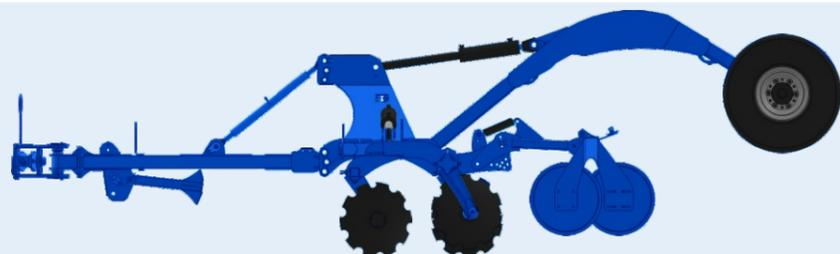
**Versión semisuspendida (lanza de tracción + carro de transporte LONG) con rodillo tándem U-ring**
