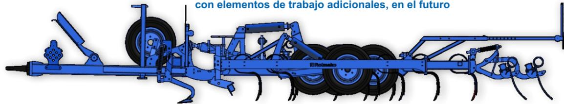
Aireador mecánico delantero Crossboard, 6 filas de púas, barra con rastrillo doble de muelles
