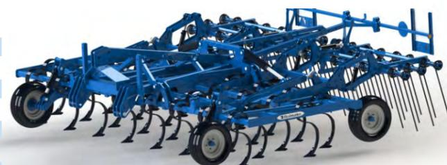
H - máquinas de plegado hidráulico, anchura de transporte no superior a 3 m.
