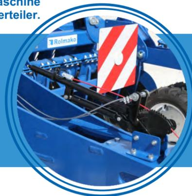
Manuelle Feststellsperre für die Hydraulikbremse
