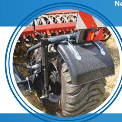
Manuelle Feststellsperre für die Pneumatikbremse
