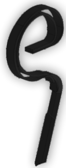
Dent droite SA 45x12 mm Coulter 40x215x6 mm
