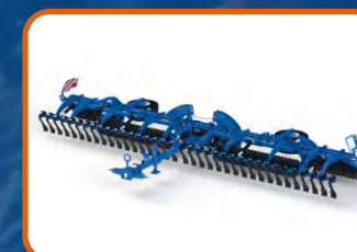
Les rouleaux à niveler le terrain et à broyer des mottes
