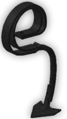
Dent défectée SN 45x10 mm
