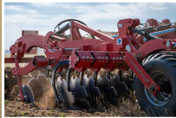
La grada de discos pesada para rastrojo U 671 sustituye perfectamente la labranza en el cultivo post-cosecha. Su robusto bastidor proporciona el peso adecuado a los discos, y su perfecta curvatura y óptimo ángulo de ataque garantizan un cultivo eficaz del suelo en una sola pasada. La grada U 671 se caracteriza por una gran separación entre los discos, lo que le permite funcionar excelentemente en suelos extremadamente duros y de secado rápido, donde las herramientas clásicas fallan.
