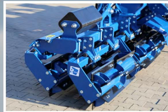
El rodillo de cuchillas TurboCut es ideal para el laboreo ultra superficial del suelo. Disponible en dos variantes: la primera con dos rodillos de corte con cuchillas rectas o helicoidales, y la segunda, el TurboCut Plus, que combina un rodillo de cuchillas con discos de corte ondulados. El TurboCut tritura eficazmente los residuos de maíz, colza y cultivos de cobertura, además de combatir las larvas del taladro del maíz en los tallos.
