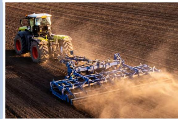
El sistema de chasis con suspensión permite combinar dos máquinas de cultivo de 4,0 m de ancho, lo que permite adaptar eficazmente el equipo a diferentes necesidades, por ejemplo, cambiando una grada de discos por un cultivador de presiembra. Esta versatilidad reduce los costes asociados a la compra de un chasis adicional, sistema de frenos y sistema hidráulico de plegado para la posición de transporte.
