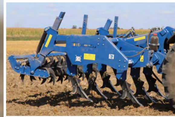
El Subsolador / Arado de cincel U624 reduce el tiempo de cultivo y baja los costos en comparación con el arado tradicional. Prepara el campo rompiendo las capas impermeables del suelo, lo que mejora el acceso del aire y del agua. Está equipado con una sección de dos filas de brazos con cortadores laterales y un rodillo de púas doble con ajuste hidráulico de profundidad, permitiendo trabajar en suelos profundos y duros.
