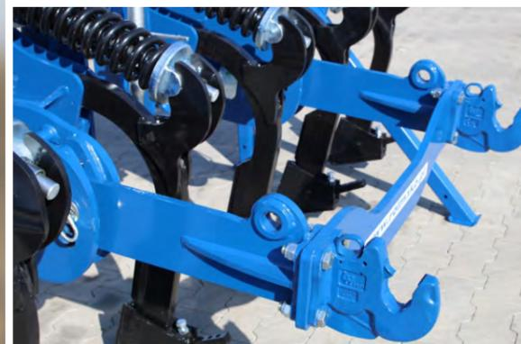
El subsolador U 632 está equipado con un enganche para implementos complementarios. Esto permite la subsolación en combinación con una grada de discos o rotativa y otras máquinas equipadas con enganche tripuntal para el tractor. El subsolador afloja el suelo por debajo de la profundidad de arado, mientras que los otros implementos conectados al subsolador realizan las labores relacionadas con el cultivo post-cosecha.
