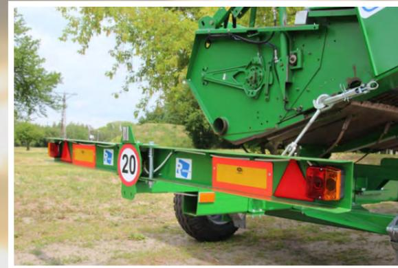
El carro de transporte sirve para transportar el cabezal detrás de la cosechadora y como almacén para el cabezal después de la cosecha. Cada carro está adaptado a un modelo específico de equipo, asegurando una carga y descarga rápida, un asiento estable y un desplazamiento seguro de la cosechadora. Está equipado con iluminación con luces combinadas y reflectores para vehículos de grandes dimensiones
