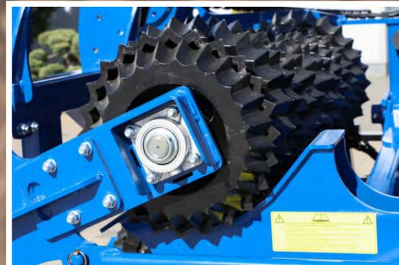
El rodillo para nivelar el campo es un implemento totalmente hidráulico que cumple con altos requisitos de calidad, eficiencia y durabilidad. Gracias al sistema hidráulico, el proceso de despliegue a la posición de trabajo y plegado para el transporte se puede realizar desde la cabina del tractor. El rodillo Cambridge es ideal para operaciones antes y después de la siembra, influyendo en la calidad de las cosechas, mientras que los rodillos Orion se utilizan para el cultivo del suelo y praderas
